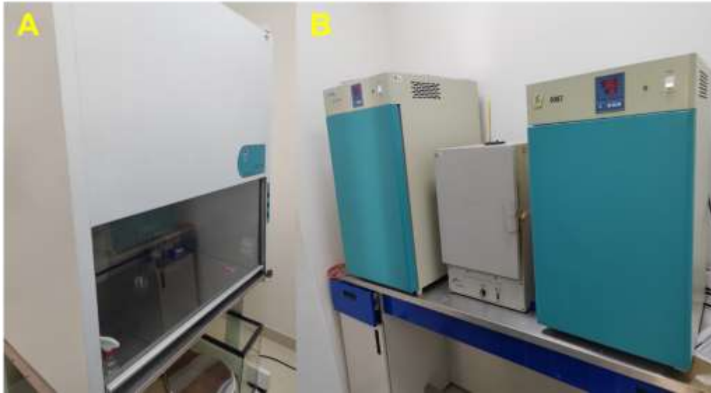
Figura 1. Equipos de laboratorio de microbiología. A) Campana de flujo. B) Incubadoras
