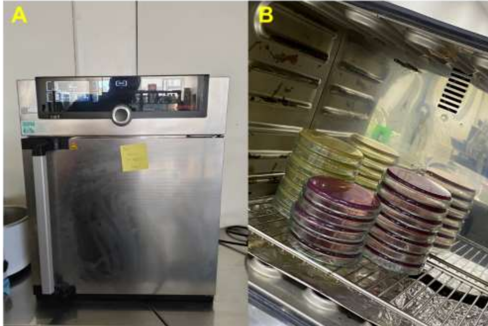
Figura 5. Incubación de muestras sembradas. A) Incubadora. B) Medios de cultivos con muestras en etapa de incubación.
